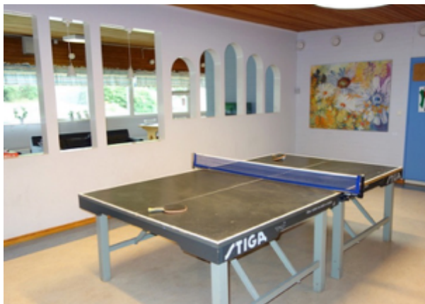
Figur 13: Ett pingisrum på en avdelning inom SiS ungdomsvård. Ett flertal fönsterlika öppningar gör det möjligt för personal att ha överblick över pingisrummet från det intilliggande vardagsrummet och vice-versa. I det här fallet låter dock öppningarna också ljud passera fritt mellan de två stora rummen. Foto: R. Ulrich
