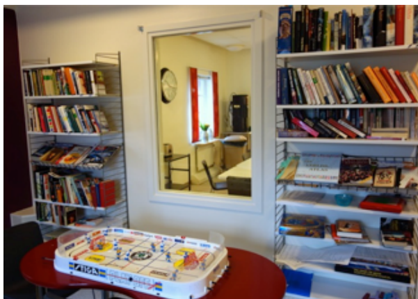
Figur 14: Fönster mellan två gemensamma rum på en avdelning inom SiS missbruksvård. Det slagtåliga glaset hindrar ljud från att passera mellan rummen. Fönstret ger personal möjlighet att hålla viss uppsikt även om det fortfarande är möjligt för boende att gömma sig i ett siktskymt hörn. Foto: R. Ulrich
