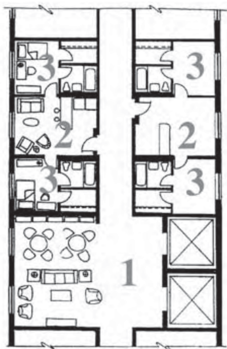
Bild 7. Möjligheter till avskildhet kommer väl till uttryck i denna grundplan. Byggnaden är indelad i olika avdelningar, från de mer offentliga (1) till de halvoffentliga (2) till de helt privata (3) (efter Evans & McCoy, 1998).
